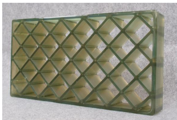
Photo 1 FRPブロック Appearance of FRP Block
